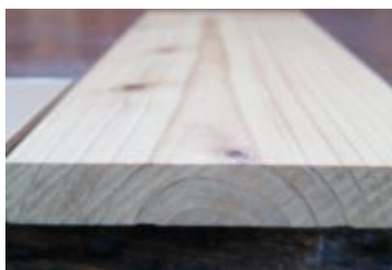
無垢材フローリングの断面
