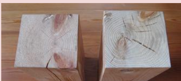
干割れの入った天然乾燥材(左)と、外見は割れていないが内部割れを起こしている人工乾燥材(右)。
